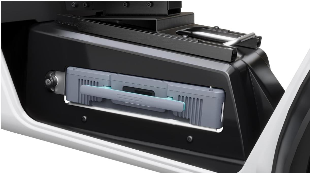
Abbildung 10: Batteriehebel gezogen
