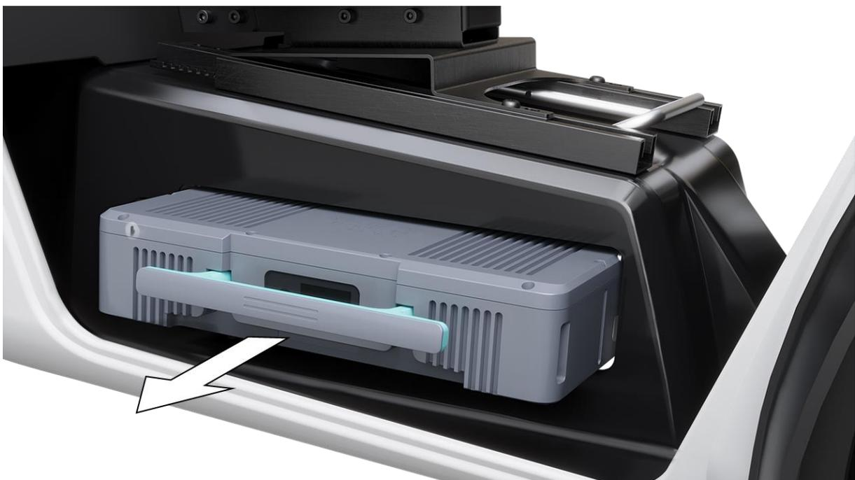
Abbildung 11: Entnahme der Batterie
