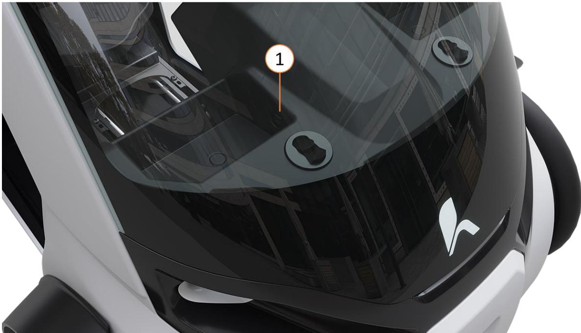
Abbildung 6: Position USB-Anschlüsse
