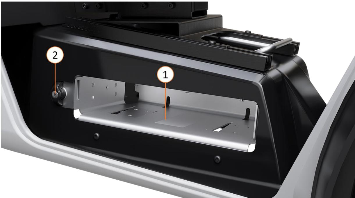
Abbildung 8: Übersicht Batteriefach
