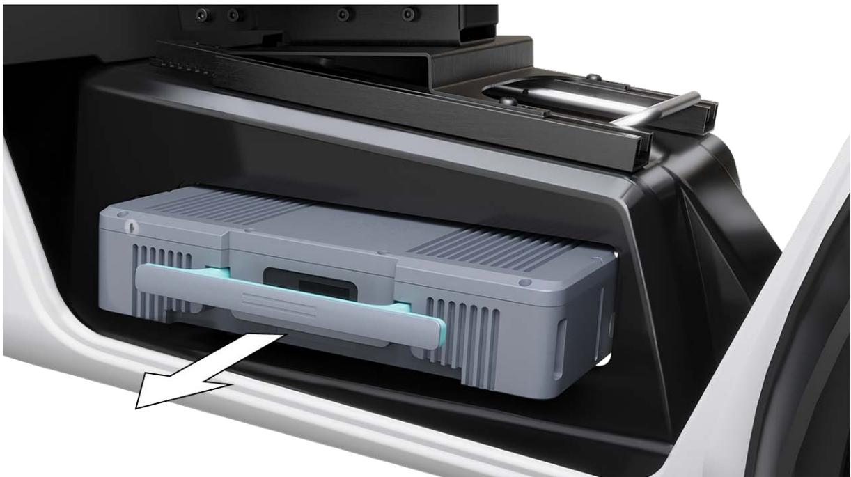
Abbildung 11: Entnahme der Batterie
