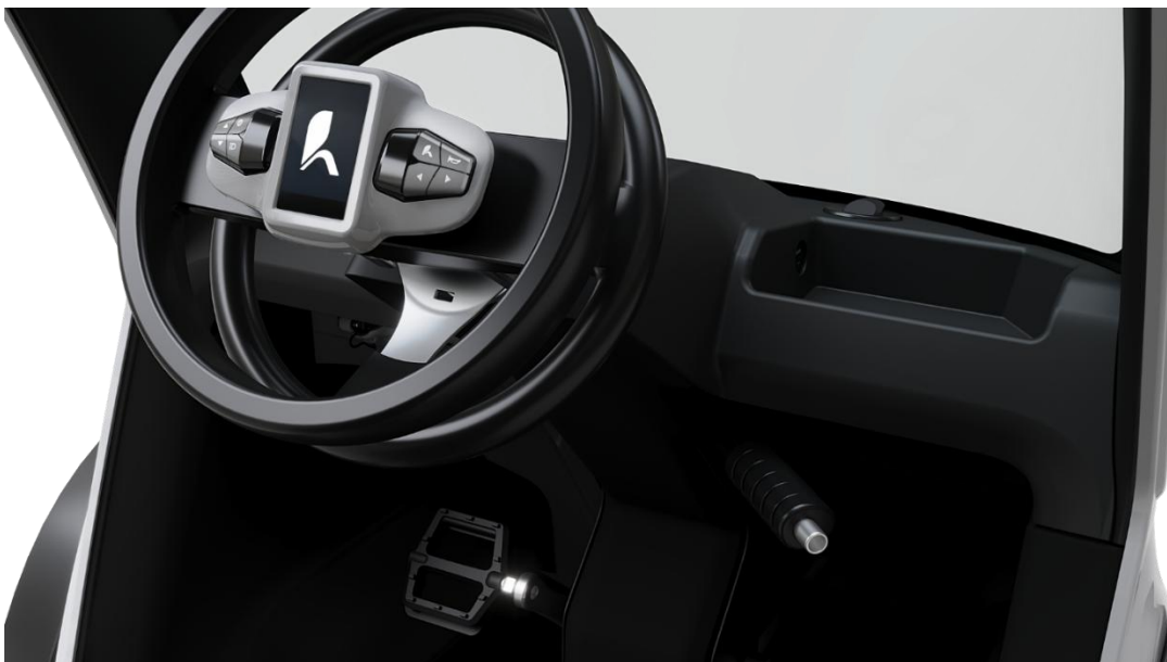
Abbildung 25: Parkbremse in Parkposition
